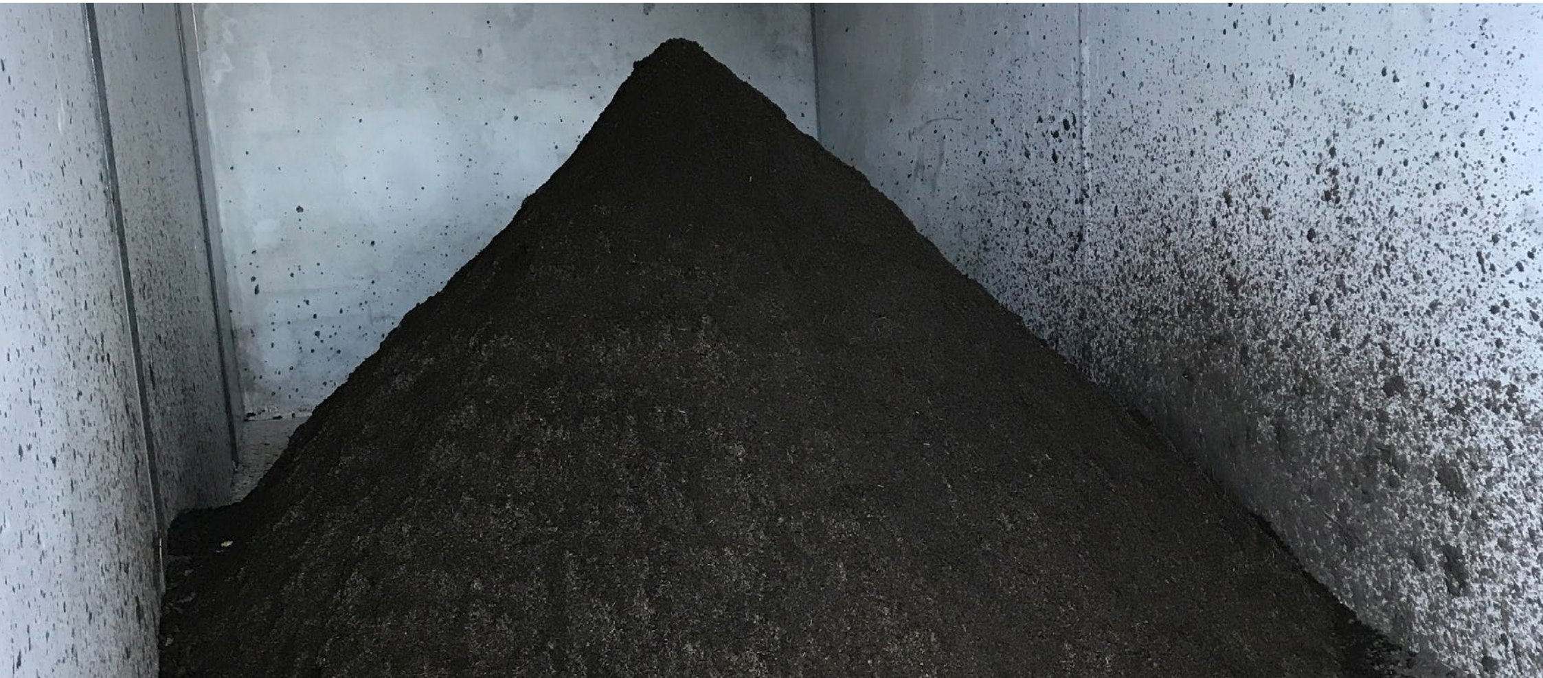
19 Dikke fractie digestaat
