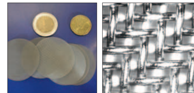
Figuur 7 Geweven metaalgaas als regenerator in een Stirlingsysteem. Links zijn een aantal gaasjes te zien, rechts een microscopische opname van een gaas. Bron: ECN
