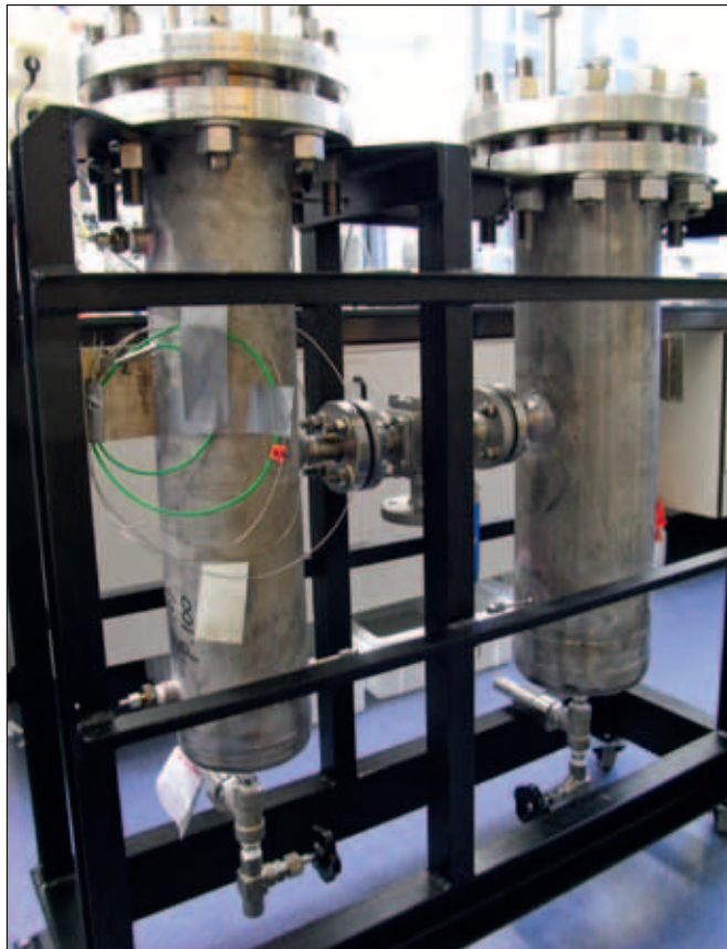
Figuur 43 Warmtetrafo van ECN met een vermogen van 1 kW.
