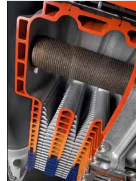
Figuur 4 Opengewerkt voorbeeld van een compacte warmtewisselaar van een HR-ketel. Bovenin bevindt zich de brander, die dus geheel met gekoeld oppervlak is omgeven. De rookgassen en het condensaat bewegen zich naar beneden. Bron: Remeha
