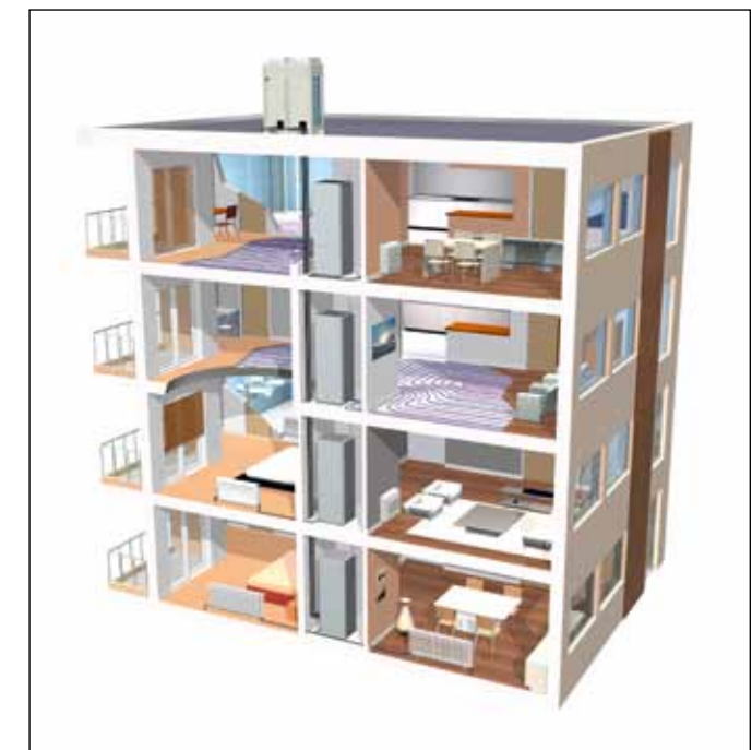
Figuur 5 Voorbeeld van een collectief systeem met een tweetraps elektrische warmtepomp. Bron: Daikin
