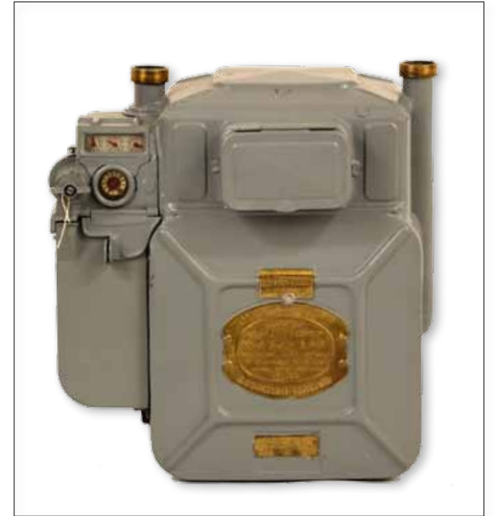
Figuur 6 Muntgasmeter. Foto: Collectie NEMO Erfgoed
